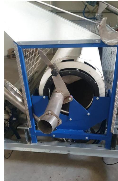
Sortie du grain dans le cylindre via la vis de déchargement ou par l'auge.
