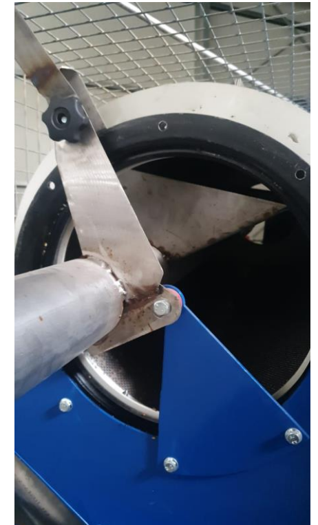
Sortie du grain dans le cylindre via la vis de déchargement ou par l'auge.
