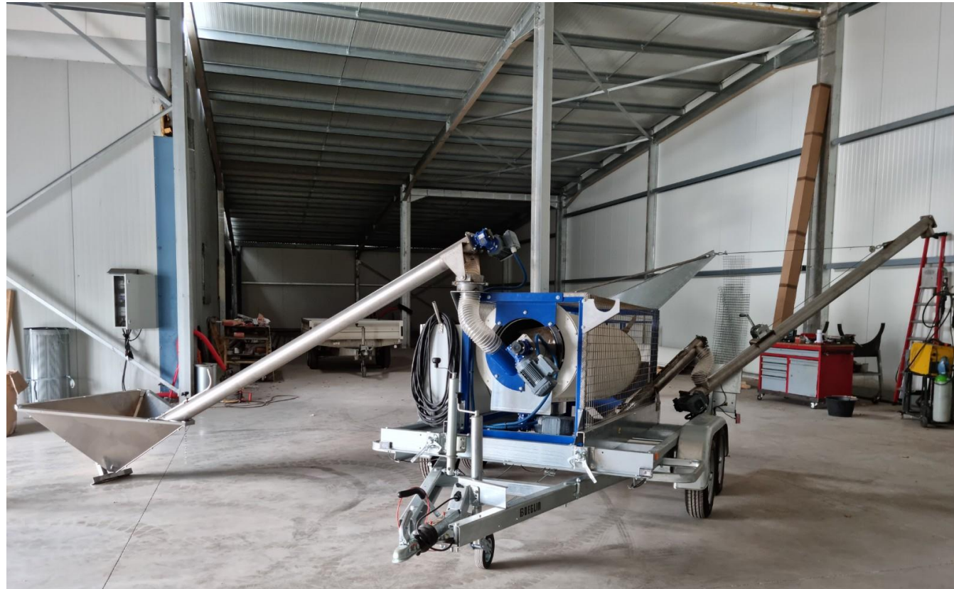
MACs avec vis de chargement et déchargement déployées
