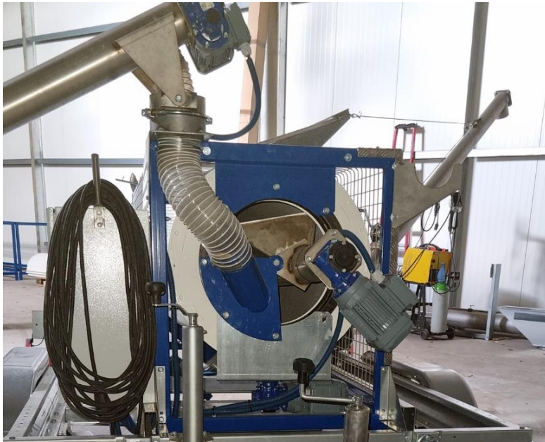
Entrée du grain dans le cylindre via la vis de chargement.
